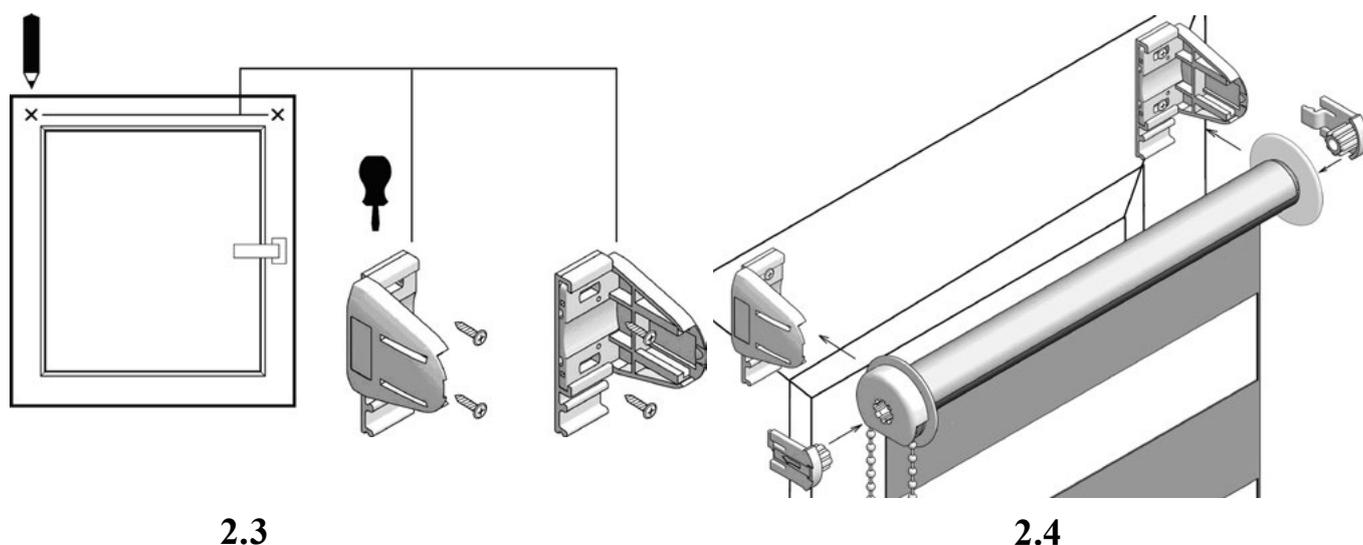
2.3. Разметить предполагаемые места крепления кронштейнов. Кронштейны должны быть установлены горизонтально. Прикрутить кронштейны шурупами так, чтобы выступы у кронштейнов накидных располагались внизу.
