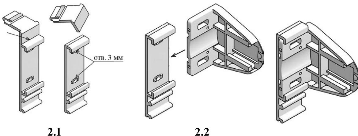
2.1. Отломать от накидных регулируемых кронштейнов верхнюю часть. Просверлить по два отверстия диаметром 3 мм на выступах каждого кронштейна.
